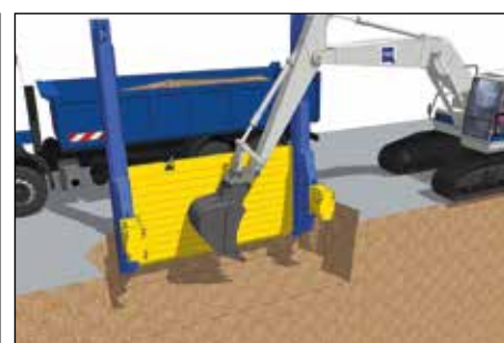
Terrasser par couches horizontales (le fond du terrassement reste constamment de niveau).
