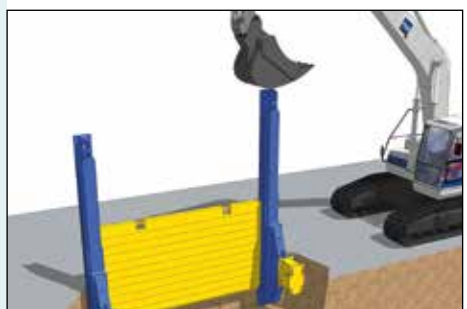
Descente des portiques par appui sur les poteaux.
