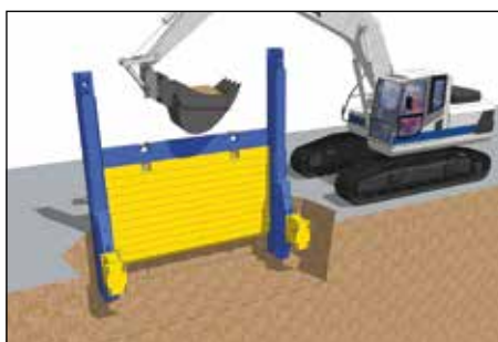
Descente des panneaux par appui du godet (chargé).
