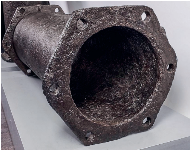
Tuyaux du parc de Versailles, en fonte moulée à noyau, assemblage boulonné avec joint en cuir, vers 1680.
