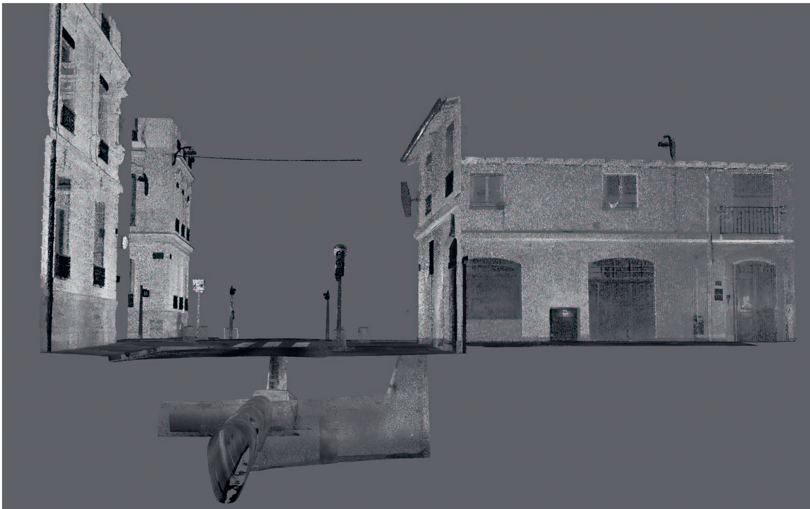
Représentation 3D, sous-sol et surface d'une place de la ville de Lyon
